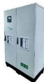
**QUADRO DE COMANDO E TRANSFERÉNCIA AUTOMÁTICO:** Será fornecido um QUADRO DE COMANDO AUTOMÁTICO com transferência aberta, Marca RODOMATIC, processador marca DEEPSEA, Modelo: DSE-4520MKII. Montado em gabinete metálico autoportante, dotado de par de disjuntores motorizados, carregador inteligente de bateria, controlador microprocessado programável.
