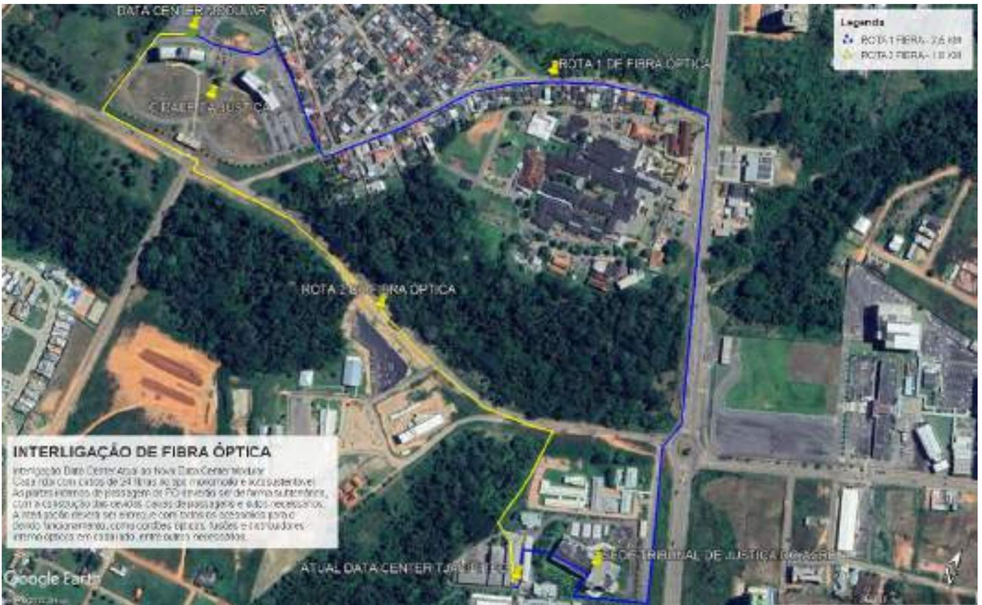
10.5.2. Deverá realizar a interligação do DCPFO por fibra óptica do tipo monomodo aos prédios do Juizados Cíveis e Fórum Criminal com cabos de no mínimo 04 fibras cada enlace, sendo 500 metros totais subterrâneos, seguindo o esquema a seguir:
